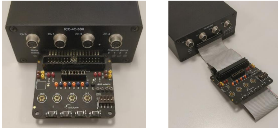
图 6: 适配板连接方式。
