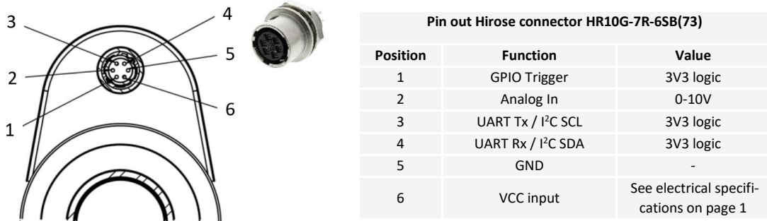
图 3: ECC-1C 电气连接示意图 (带母型 Hirose 连接器)
