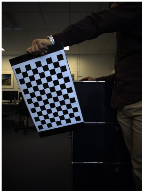
图 5：用于校准广角相机以纠正镜头畸变的棋盘格示例图像。
