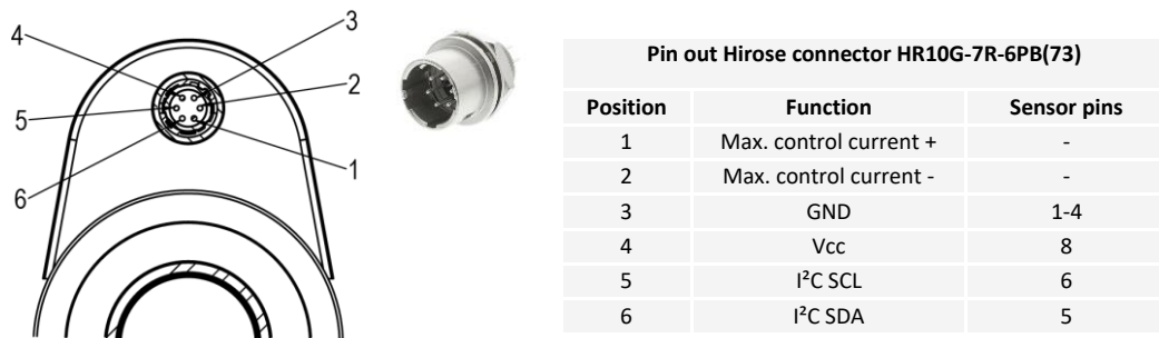
图 6: 不带内置控制器的镜头型号电气连接示意，使用（公）Hirose 接头。
