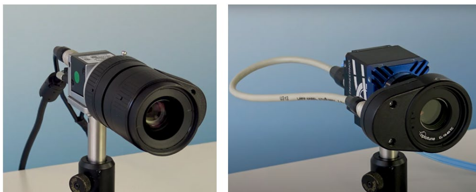
图 2. Optotune 液态透镜与 Basler（左）和 ITALA（右）相机的集成
