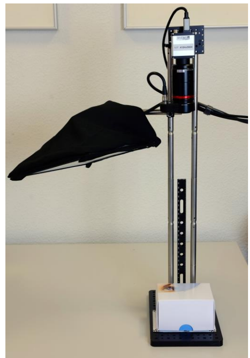
图5：机器视觉系统配置示意图。系统由C接口工业相机、50mm定焦镜头以及可调焦液态透镜组成，采用前置透镜配置方式。
