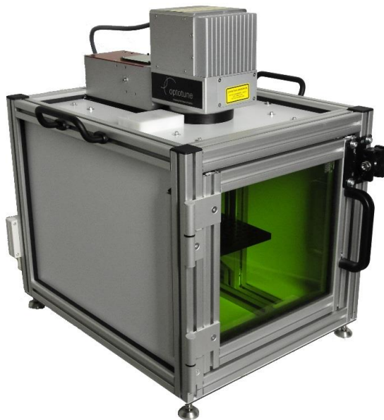
图 2: 激光打标系统示意图, 采用电动可调焦透镜 EL-10-42-OF 及其模拟控制器 EL-E-OF-A, 实现快速 Z 轴聚焦。
